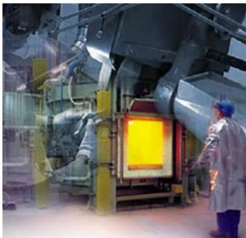
con el aire, y se somete a un enfriamiento gradual, tras el cual se procede a eliminar el material cerámico, por impacto a martillo, chorro de agua a presión y granallado.
