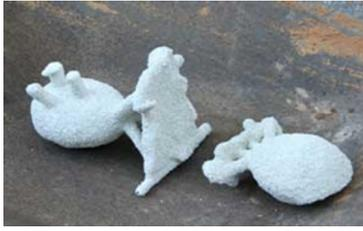
El molde cerámico se va formando tras la inmersión sucesiva del racimo de cera, primero en un baño de polvo cerámico en suspensión (base agua o base alcohol), y posteriormente en una lluvia de polvo cerámico. Una vez el molde ha adquirido el grosor deseado, y tras un proceso de secado, se introduce en la autoclave
