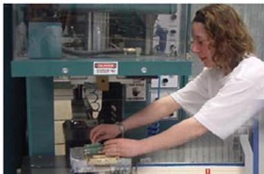
Los utillajes para la inyección de la cera se adquieren a terceros. Se fabrican en aluminio o en acero inoxidable. Castings finaliza su fabricación mediante pequeñas operaciones de fresado y torneado.
