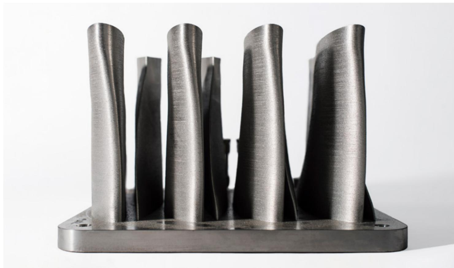
Piezas diseñadas y producidas mediante fabricación aditiva.
