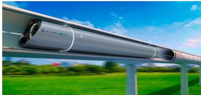
El sistema aerodinámico propulsivo, un elemento esencial de la propuesta de Zeleros, está integrado en el vehículo y es impulsado por un sistema de propulsión 100% eléctrico. Esta tecnología es clave para minimizar la necesidad de motores lineales a lo largo de la pista y para reducir el coste de infraestructura, facilitando la escalabilidad de hyperloop para su implantación global.
