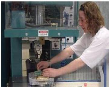
Los utillajes para la inyección de la cera se adquieren a terceros. Se fabrican en aluminio o en acero inoxidable. Castings finaliza su fabricación mediante pequeñas operaciones de fresado y torneado.
